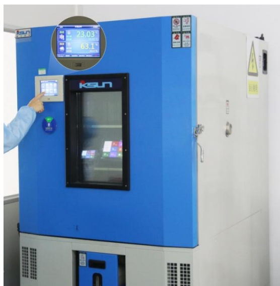
图 5-3 高低温老化测试图
